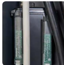
Der NORDMANN Omega Pro verfügt über zwei unabhängige Schwimmersysteme.
